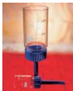
Filtrieraufsatz mit PP 1 -Trichter und 2 FKM 1 -Dichtungen
